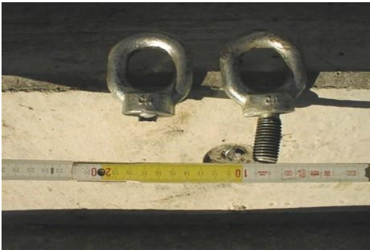
IMAGEN DEL CÁNCAMO ROTO Y DE OTRO DAÑADO EN SU USO
